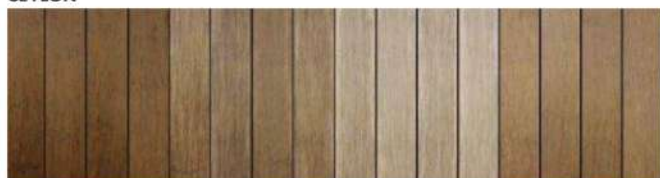
Dopo installazione Dopo 1 anno Dopo pulizia Dopo manutenzione
